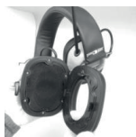
4. Når du plasserer den nye øreputen, skal den delen av øreputen som er halvrund være øverst.
